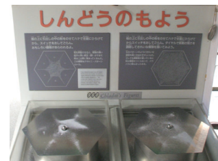
図-2 神戸市立青少年科学館におけるクラドニパターンの展示。同じ形の板が並んでいるが、見学者が自分で加振する周波数を自由に調整することができるので、様々なパターンを観察できるようになっている。
